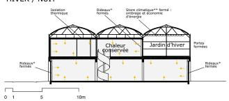
Au rez-de-chaussée une structure poteaux-poutres en béton porte une plateforme, à une hauteur de 3 m, sur laquelle sont fixées des serres horticoles. La structure est en acier galvanisé, les parois en polycarbonate transparent. Une partie de la serre est isolée et chauffée. L'autre partie constitue un jardin d'hiver largement ventilé en toiture et en façade.
